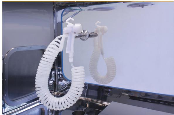
Eine installierte Spritzpistole erleichtert die Reinigung des Isolators. Sie arbeitet mit zwei Medien und wird über ein Ventil am HMI-Touchscreen gesteuert. Zum Reinigen wird die Kammer an die Wasserleitung angeschlossen und anschließend durch das Umschalten der Druckluft getrocknet.
