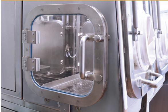
Die Materialübertragung aus der Hauptkammer in die Umgebung oder aus der Kammer zu anderen Geräten (z. B. einem Laborabzug) ist über eine Flügeltür möglich. Betätigt wird sie mithilfe eines Türverriegelungsmechanismus. Das Türmaterial besteht aus AISI 316L (1.4404) Edelstahl, Sicherheitsglas und Silikondichtung.
