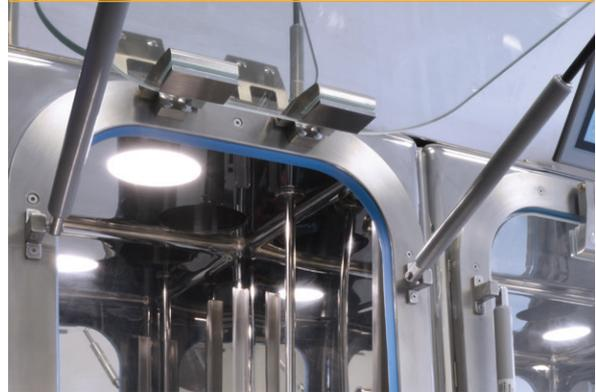
Aufblasbare Dichtung, Sicherheitsglas mit Flanschen mit Hülsen. Integrierte Sensoren überwachen ein sicheres Schließen, eine Gasfeder ermöglicht ein einfaches Öffnen des Fensters.
