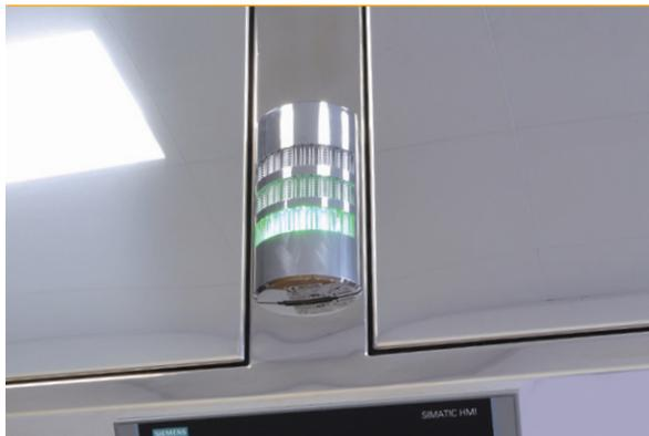
Ein Leuchtsignal und akustischer Alarm bieten dem Benutzer einen schnellen Überblick über Betriebs- und Fehlerzustände.
