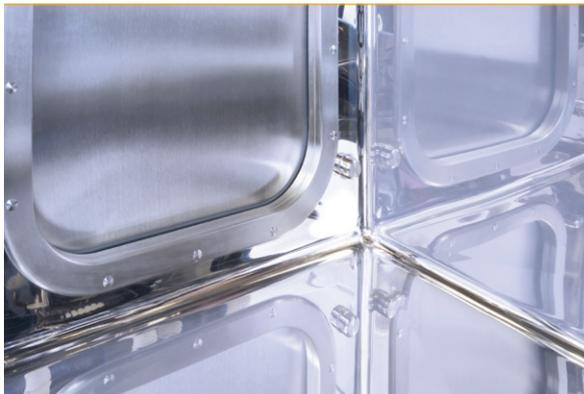
Abgerundete Ecken und hochglanzpolierte Oberflächen ermöglichen eine einfache Reinigung der Materialschleuse und Hauptkammer. Die Materialschleuse und Hauptkammer sind präzisionsgeschweißt, was ihre Dichtheit garantiert.
