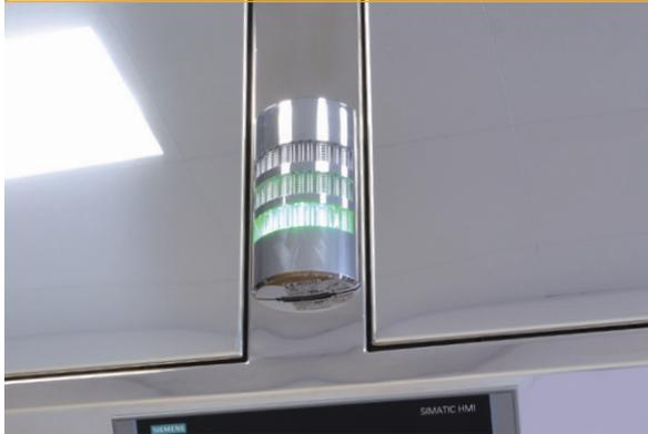
Leuchtsignal und akustischer Alarm bieten dem Benutzer einen schnellen Überblick über den Betrieb und mögliche Störungen.
