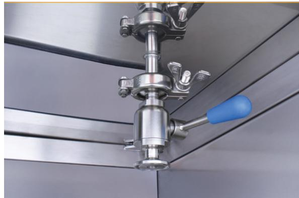
Zum Auslassen von flüssigen Abfällen, die bei Sterilitätstests entstanden sind. Anschließbar an einen Sammeltank oder Zentralabfall.
