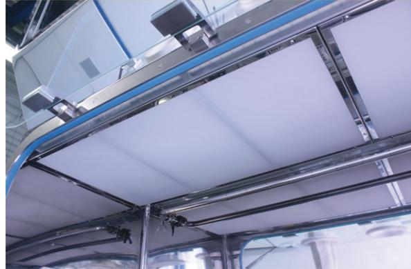
Die Kammerdecke ist mit einem speziellen Rahmen zur Regelung der Luftströmung und mit LED-Leuchten ausgestattet. Über dem Rahmen befinden sich die HEPA-Einlassfilter.
