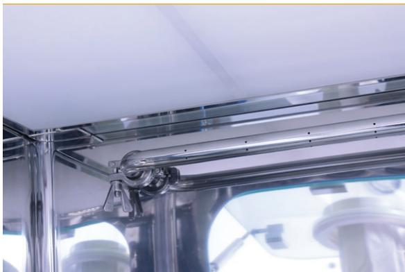
Die gleichmäßige Verteilung des Wasserstoffperoxid-Dampfes wird durch ein gelochtes Rohr gewährleistet, das über die gesamte Länge der Kammer installiert ist.
