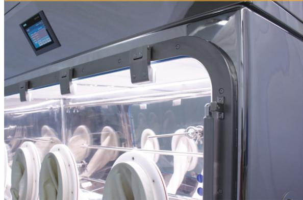
Aufblasbare Dichtung, Sicherheitsglas mit Flanschen und Hülsen. Sensoren zur Überwachung des sicheren Schließens des Fensters, Gasfedern zum einfachen Öffnen.
