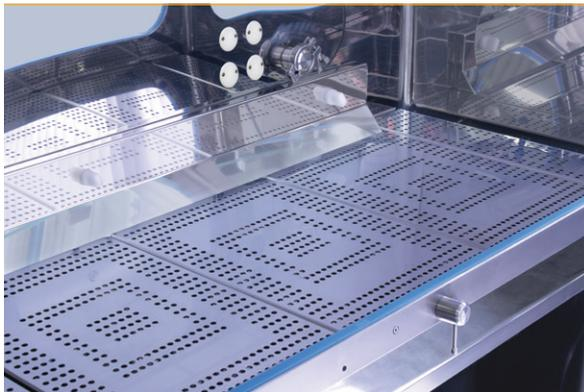
Die Arbeitsplatte weist sechs Lochgitter auf, die mit einem Gerät zur Sterilitätsprüfung ausgestattet werden können.
