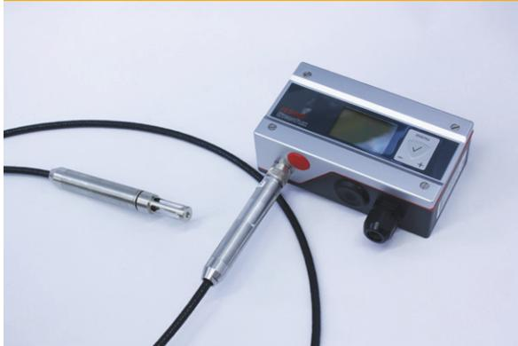
Dieser Sensor kontrolliert die Prozessdekontamination. Rotoronic ist ein präzises und hochwertiges Produkt, beständig gegen Wasserstoffperoxid-Dämpfe.
