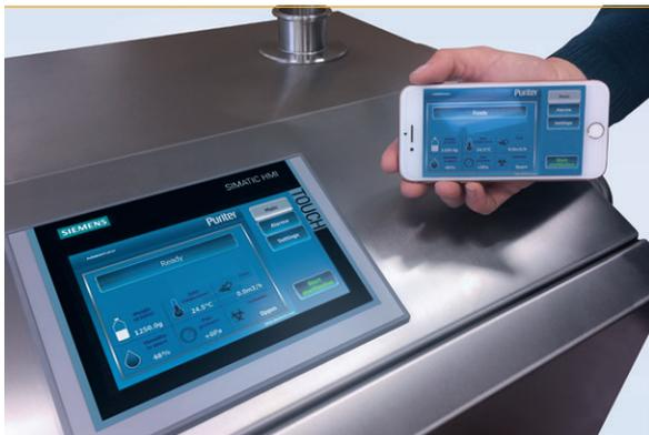
Mithilfe der Smart Client-Anwendung ist die Fernsteuerung des Wasserstoffperoxiddampf-Generators über ein Mobiltelefon möglich. Das Gerät verfügt über ein eigenes WLAN, mit dem sich der Benutzer verbindet. Nach dem Herstellen der Verbindung wird auf dem Mobiltelefon dieselbe Schnittstelle wie auf dem Bedienfeld angezeigt, sodass eine Fernsteuerung problemlos möglich ist.
